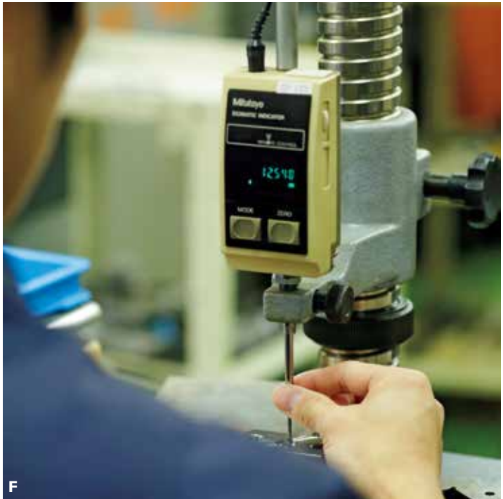
E.加工後の製品のバリ取りは顕微鏡を覗きながら行う。高い品質を担保するには、最終的には人の目が必要になる。リクルートにも力を入れ、スタッフは若返った。F.細かく数字を確認しながら、穴あけ加工を行う。
