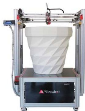
再スタート機能、フィラメントの予備能力機能を開発し、スムーズなフィラメントの引継ぎを行う機能を新たに付加。押出造形方法の価格帯を維持し、製作造形範囲が700mm立方まで対応可能な3Dプリンタを開発しました。
