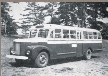
昭和23年に導入したディーゼルエンジンを搭載した民生産業のボンネットバスKB3B(60人乗り)。
