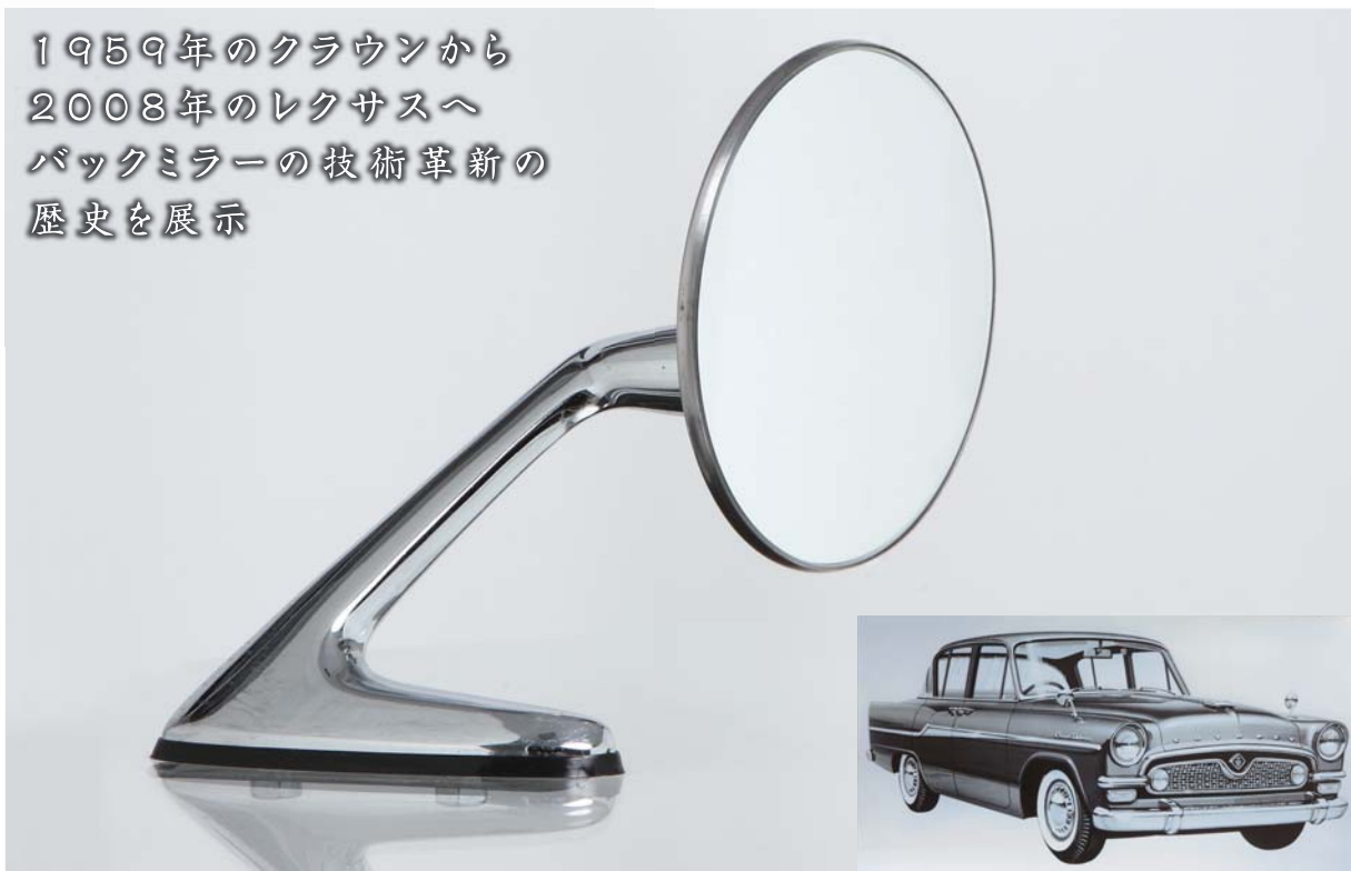
株式会社村上開明堂が初めて手がけたフェンダーミラー。昭和34年(1959)のトヨベツ クラウンに搭載。フェンダーミラーは直径110mmの丸型で銀鏡。
